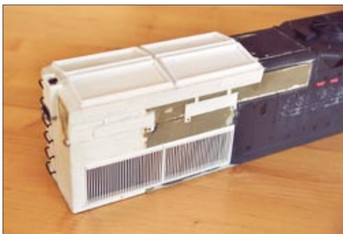
Das Heckteil und die vordere Dachpartie im Rohbau, hier fertig verspachtelt und im Vergleich dazu Ansichten des fertigen Modells
